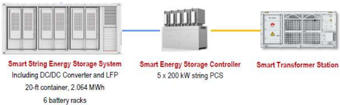
Figur 6. BESS koppas till Smart PCS som ansluts till en STS (smart transformer station)
