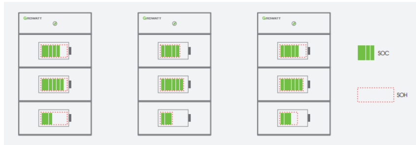
Figur 19. APX-batterimoduler har inbyggda DC/DC-optimerare vilket möjliggör att gamla och nya batterimoduler kan blandas och systemet kan enkelt byggas ut i framtiden.
